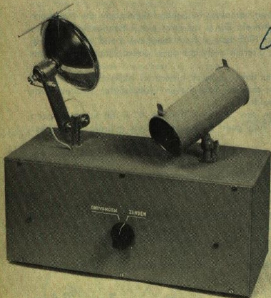
LUXA-VOX zend/ontvanger. Links boven de schijnwerper om te stralen en rechts de ontvangkoker waarin de lghg. Met de knop wordt omgeschakeld van zenden op ontvangen.
